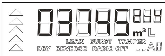
Показания MULTICAL® 21 можно считать с большого четкого специально разработанного дисплея. Целые кубометры отображаются пятью большими знаками. Три маленьких знака – знаки после запятой. Знак L (справа от м<sup>3</sup>) должен всегда не гореть при эксплуатации, так как используется только при производстве и проверке счетчика. Стрелки в левой части дисплея отображают наличие потока через счетчик. Если расход отсутствует, все стрелки не будут гореть.
